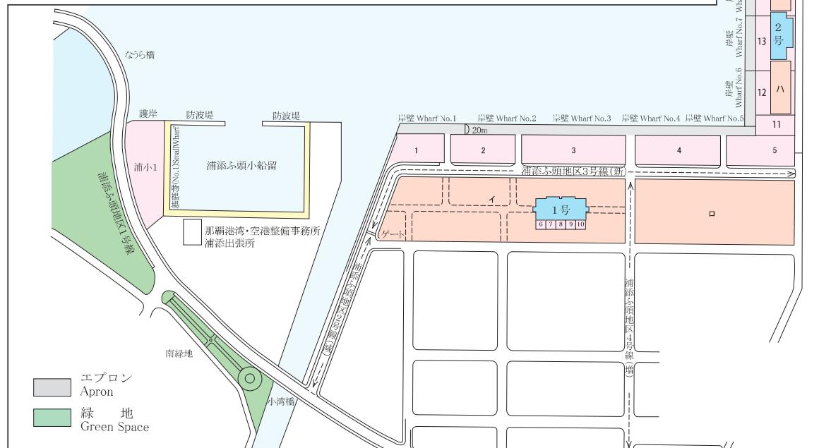
浦添ふ頭はセメント、雑工業品を取り扱うふ頭として水深-7.5~-9.0m、総延長1,120mの内貿バースが計画され、現在7バース(延長910m)が供用している。2015年の取扱貨物量は1,775,550トン(出貨:179,726トン、入貨:1,595,824トン)となっている。
