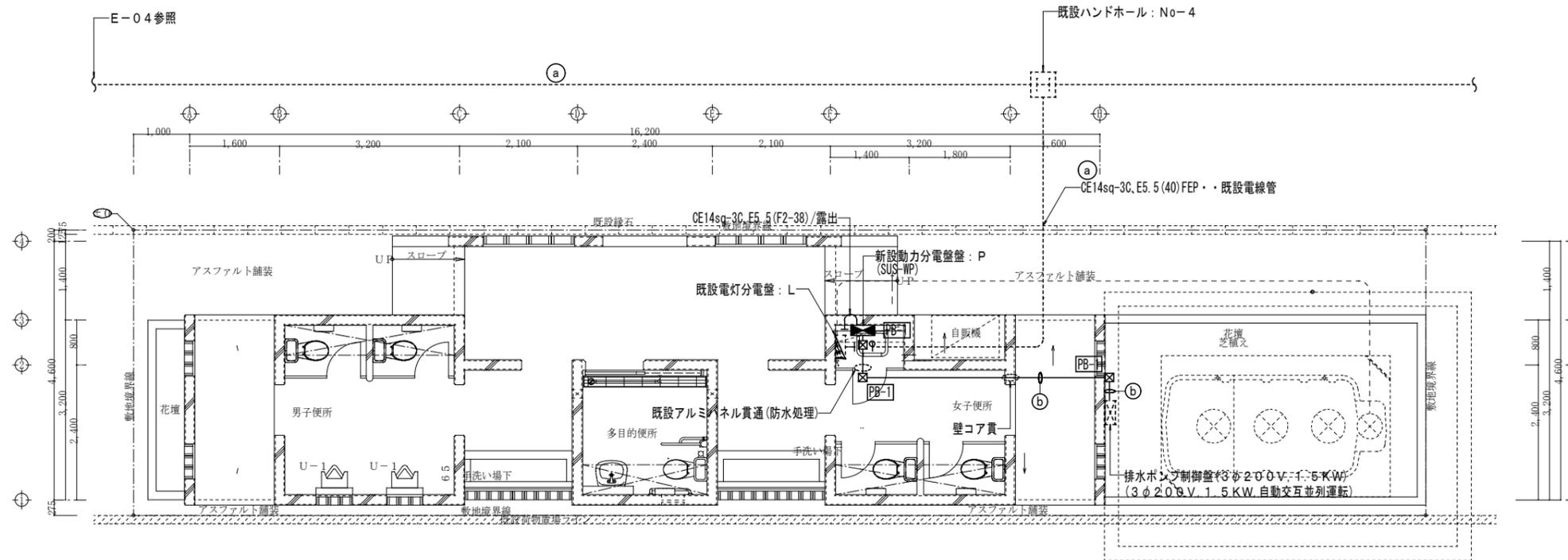
1階幹線・動力設備配線図 S=1/100
