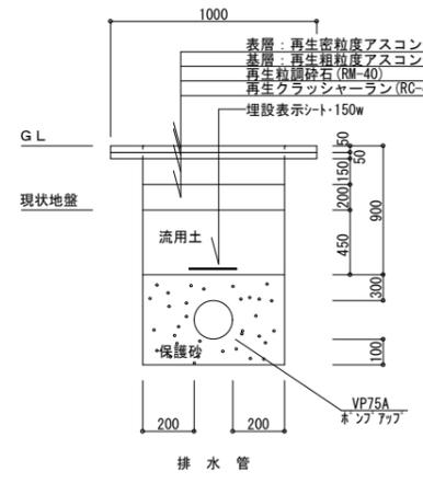
港内道路部分配管布設要領図 NO-SCALE
