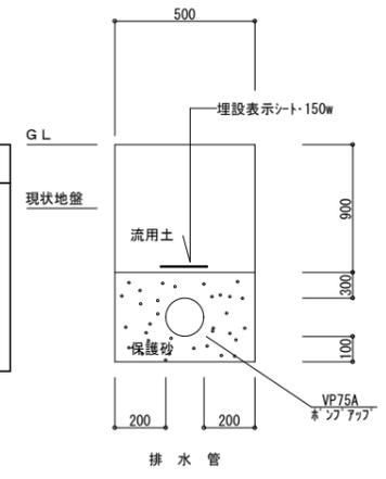
港内道路部分配管布設要領図 NO-SCALE
