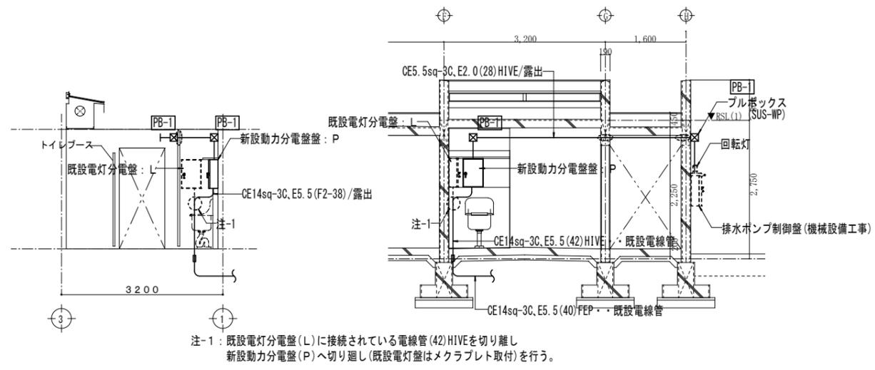
注-1：既設電灯分電盤(L)に接続されている電線管(42)HIVEを切り離し
