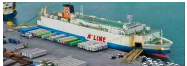
※RORO 船：トラックやトレーラーが、船首や船尾のランプウェイから自走で船内に乗り降りする船舶。クレーンによる荷役作業が不要なため、迅速な荷役やクレーン等の設備がない港湾でも荷役が可能。
