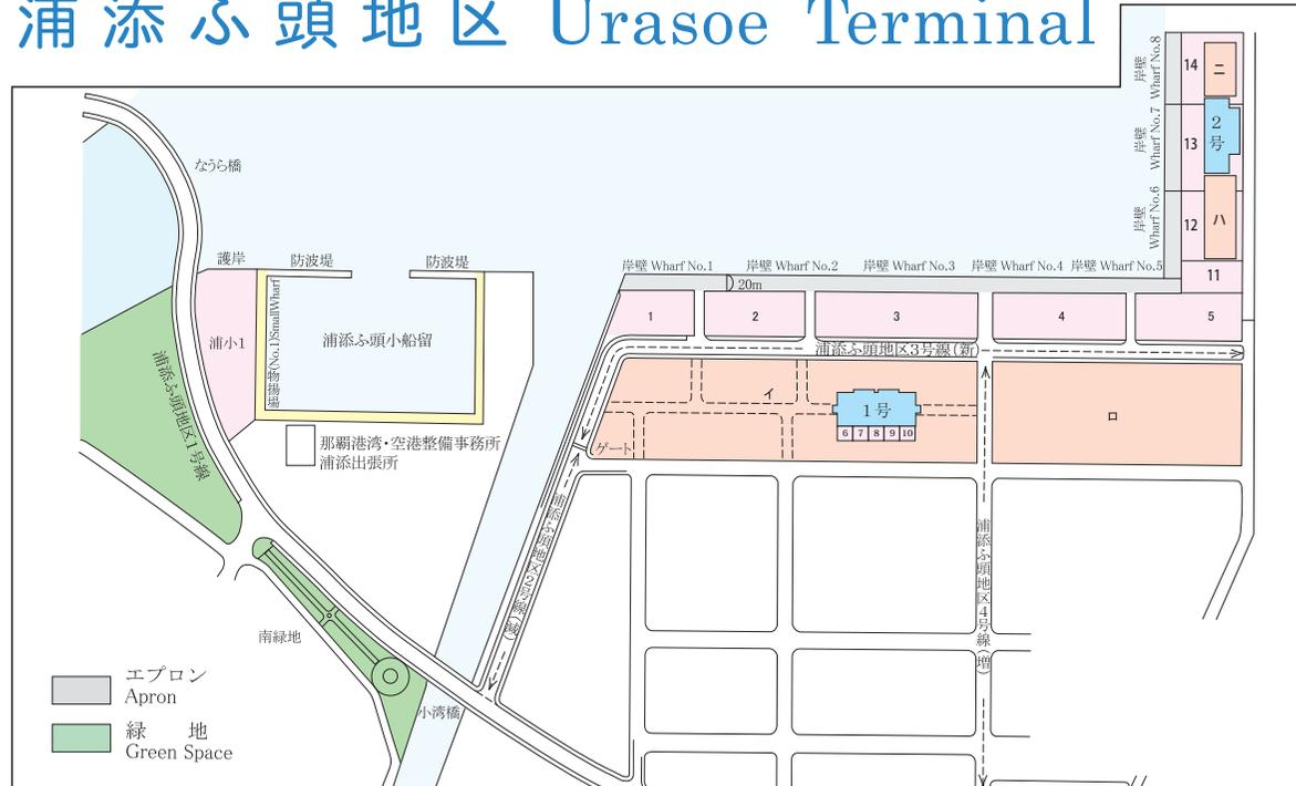
浦添ふ頭はセメント、雑工業品を取り扱うふ頭として水深-7.5~-9.0m、総延長1,120mの内貿バースが計画され、現在7バース(延長910m)が供用している。2015年の取扱貨物量は1,775,550トン(出賃:179,726トン、入賃:1,595,824トン)となっている。
