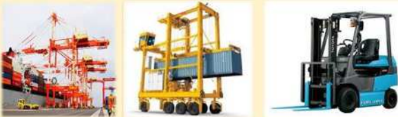
ガントリークレーン ストラドルキャリア フォークリフト
