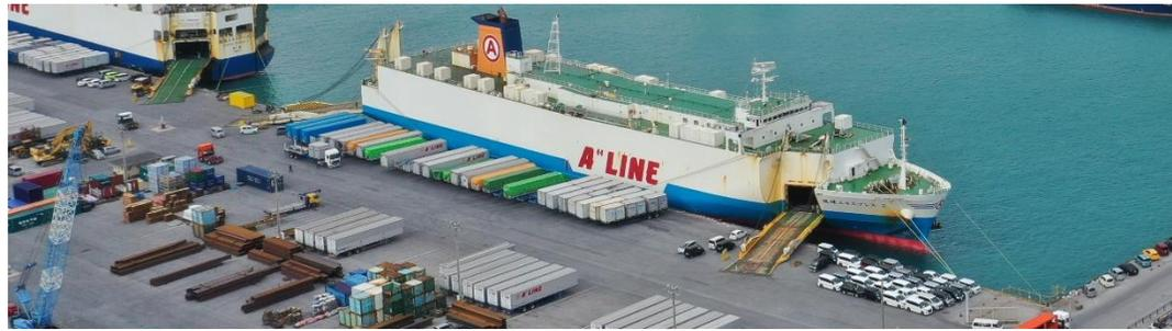
※RORO船:トラックやトレーラーが、船首や船尾のランプウェイから自走で船内に乗り降りする船舶。クレーンによる荷役作業が不要なため、迅速な荷役やクレーン等の設備がない港湾でも荷役が可能。
