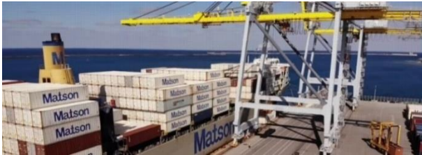
※コンテナ船：貨物を詰めたコンテナを大量に輸送する船舶。主に岸壁に設置されたクレーンによる(荷揚げや荷下ろし)を行う。
